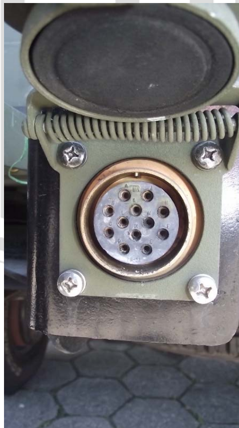
Figura 5A – Tomada militar com 12 pinos para reboque
