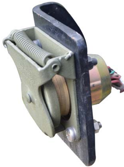
Figura 5 – Tomada militar com 12 pinos para reboque
